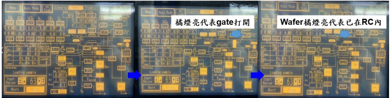
Loading sample:透過晶圓傳輸系統，機械手臂將holder傳送進RC內
